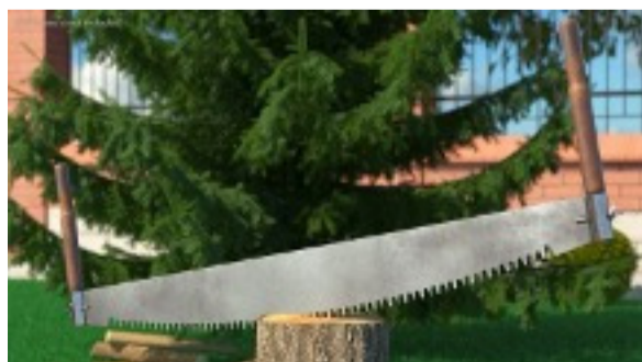
(kur): girdebir (tir): iki kişilik testere (fra): scie à deux manches (İng): two-man saw
